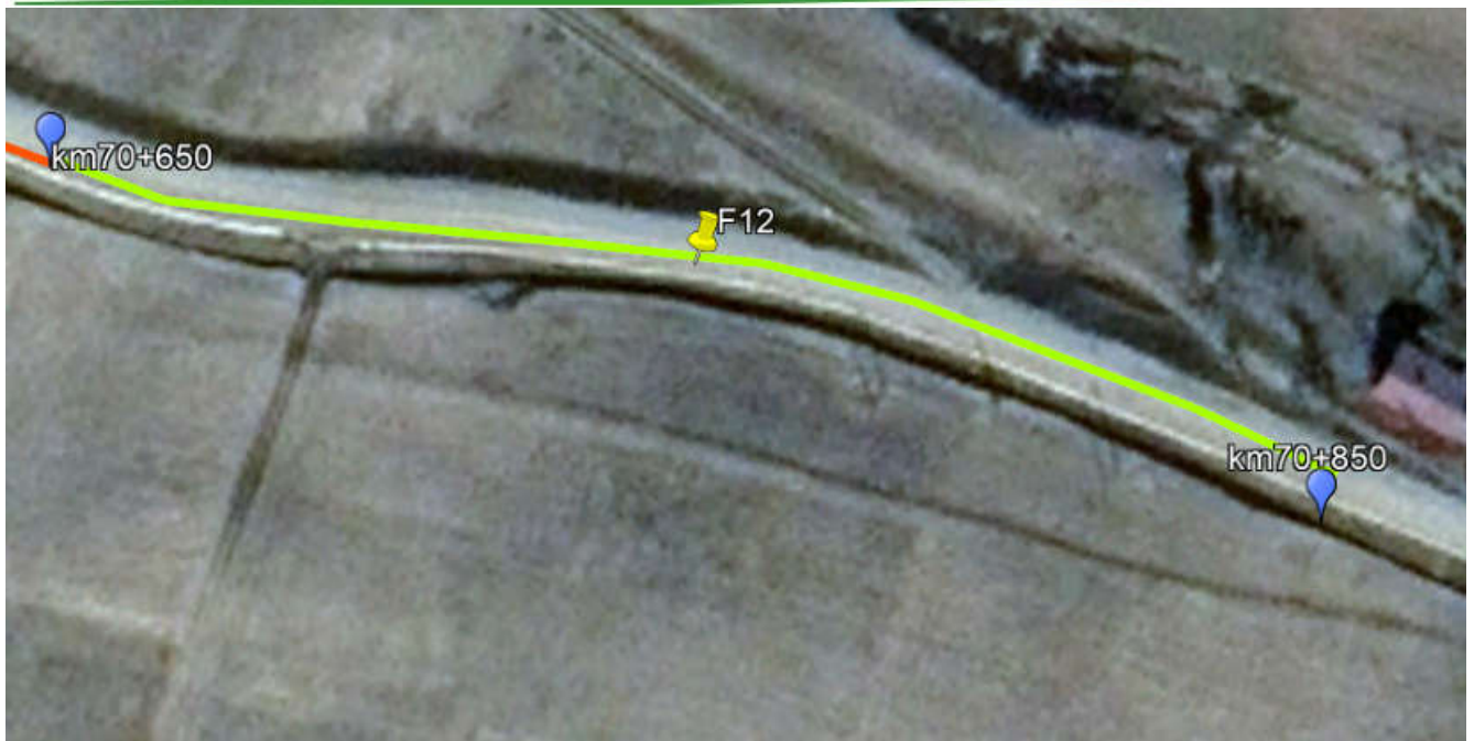
Fig. 14. Dispunere investigații geotehnice
